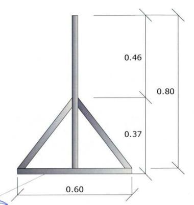
BASTIDOR FABRICADO CON PTR 1 1/2" x 1 1/2" x 3.00mm Galvanizado.
